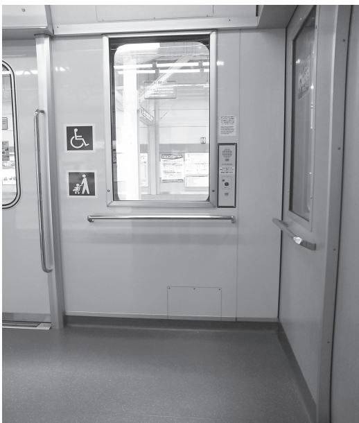
図1 東京メトロ東西線の車いすスペース
