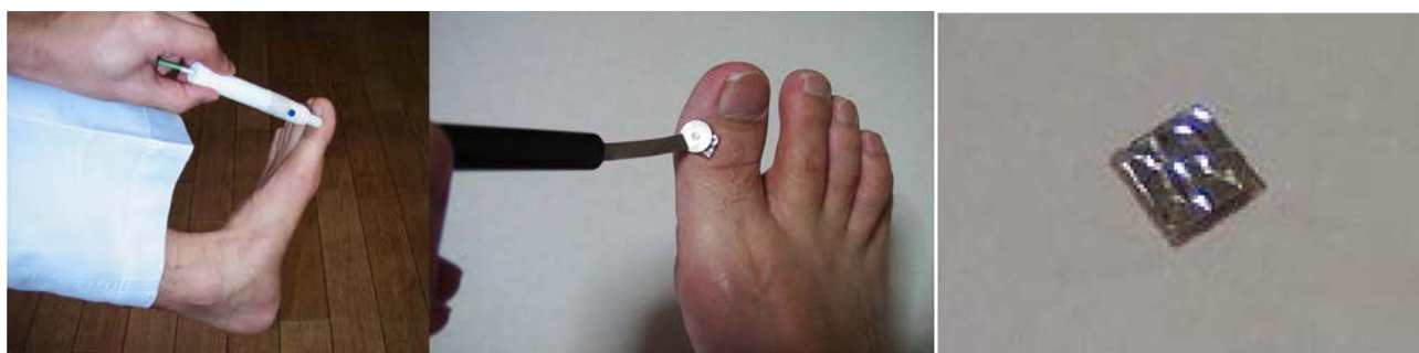
図5 脾経井穴における測定（左：アミカ、中央：プリケアナディ、右：プリケアナディに用いる銀箔-ゲル電極）
